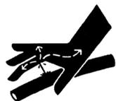
Não verifique vazamentos no circuito hidráulico com as mãos, a alta pressão pode provocar grave lesão.
